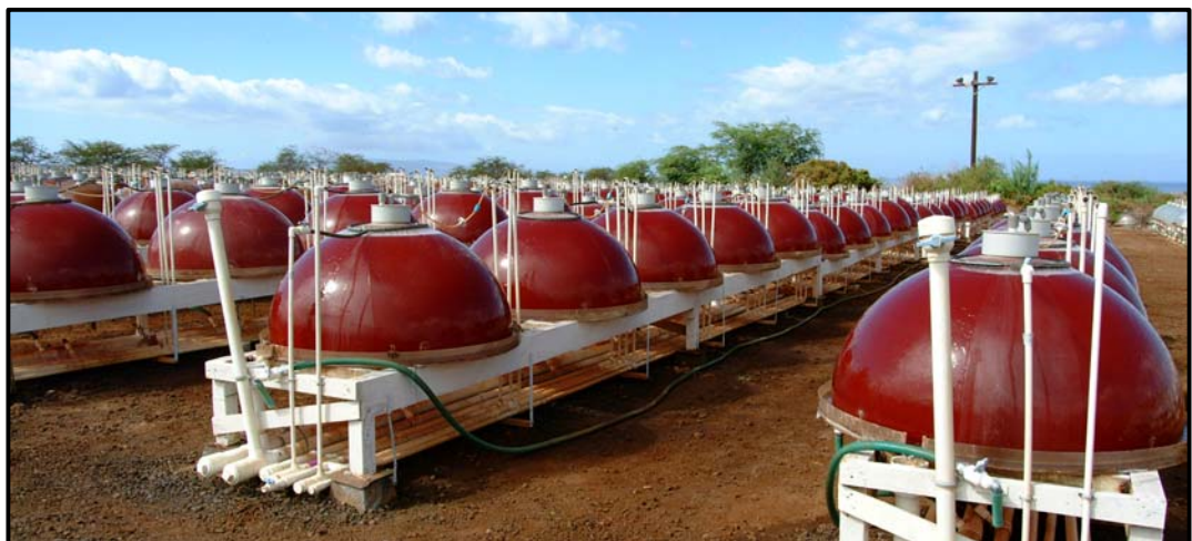
<사진 4-10> 마우이섬 Kihei 하수처리장 방류수를 이용해 녹조류를 배양하는 모습
