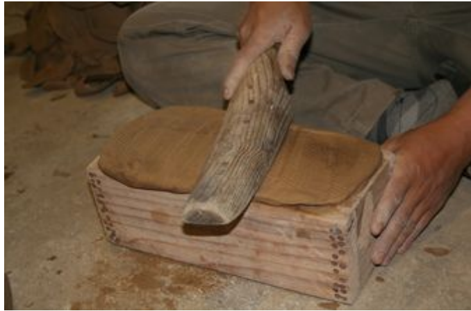
그림 98 아취벽돌만들기 벽돌의 크기에 맞춰 틀을 제작하고 그림과 같이 흙을 넣고 방망 이로 두들긴다.
