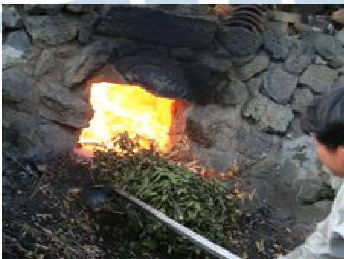
그림 120 큰불-섬피넣기1 제주돌가마 소성의 가장 큰 특징이다. 이 과정은 섬피(나무가지 묶음)을 아궁이 입구에 놓고 불작대기를 이 용하여 아궁이 안으로 집어 넣는작업이며 반복적으로 진 행한다.
