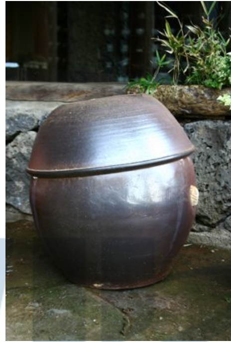
그림 135 4차 소성 결과-비교적 높은 온도에 이른 것으로 보이며 위쪽에 앉은 재가 덜녹아 거친 모습을 보인다.
