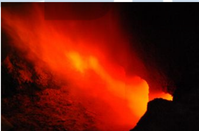
그림 129 창불질 후 뒷구멍 창불질한 후 가마 뒷구멍을 보면 불이 뒷구멍 밖으로 나온다.
