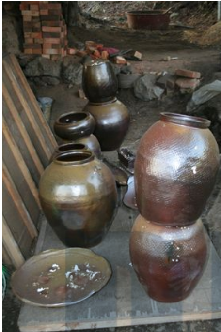
그림 134 4차 소성 결과-항아리 두 개가 무게에 의해 기울어져 있다.
