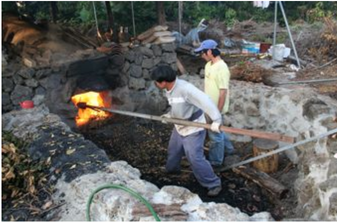
그림 121 큰불-섬피넣기2 아궁이 속으로 섬피를 넣고 살짝 들어 올린다. 그러면 섬피가 큰 불길로 변하면서 가마 뒷구멍으로 연기가 심하게 발생한다.
