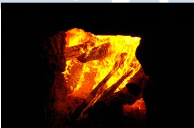
그림 117 중불1 불이 어느정도 커지는 불로 굽기가 있는 나무를 이용하여 소성한다.
