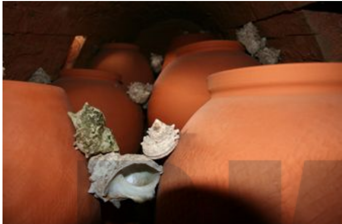
그림 107 가마재임 구쟁기탁살(소라껍데기)을 이용하여 기물과 기물사이에 놓아 재임한다.
