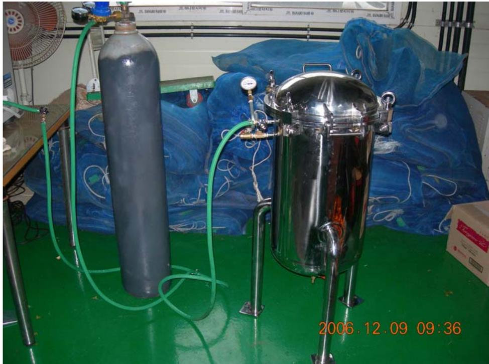
Fig. 7. GABA 혐기처리 충전기 사진.
