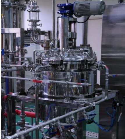
그림 4-2. 좌:에탄올 및 메탄 발생장치, (우)메탄가스 포집장치
